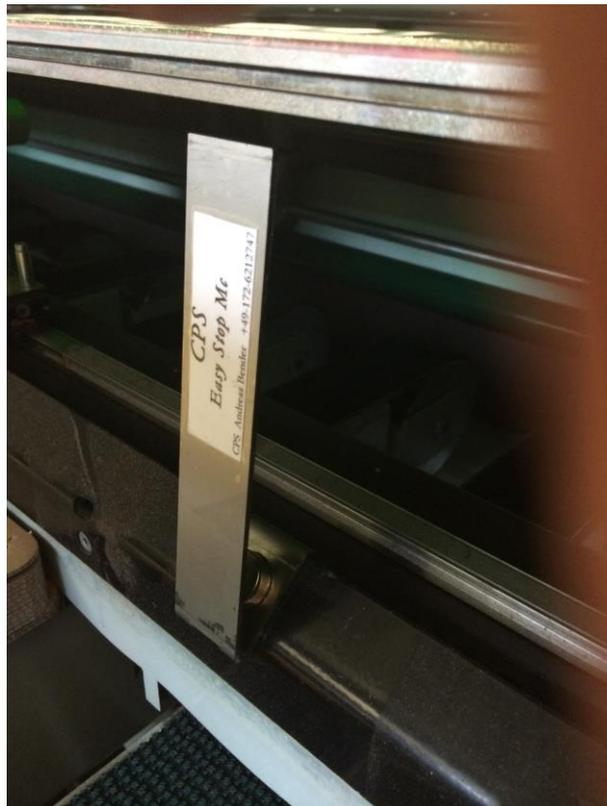
**Der CPS Easy Stop-MC ist ein, patentierter, Bogenanschlag für die Auslage der Bobst Mastercut.**
