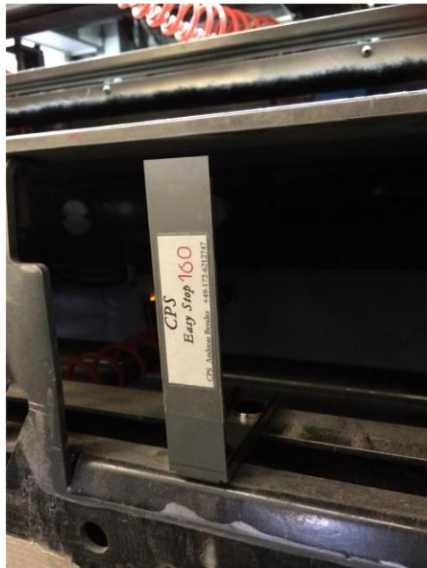
**Der CPS Easy Stop-160 ist ein, patentierter, Bogenanschlag für die Auslage der Flachbettstanze Bobst SPO 160 A-Matic.**
