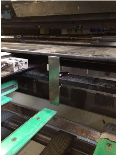
**Der CPS Easy Stop-160-Vision ist ein, patentierter, Bogenanschlag für die Auslage der Flachbettstanze Bobst SPO 160 Vision.**
