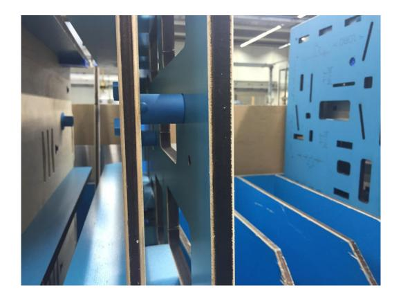
Der CPS-Easy-Fix reduziert die Menge des benötigten Kunststoffes deutlich und benötigt nur einen Bruchteil der bisherigen Montagezeit. Zur Montage werden keine Hilfswerkzeuge oder Schrauben benötigt.
