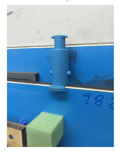
Der CPS-Easy-Fix besteht aus nur einem Teil und verbindet ohne jede Schraube oder benötigtes Werkzeug die Ausbrechformen zu Transport oder Lagerung.
